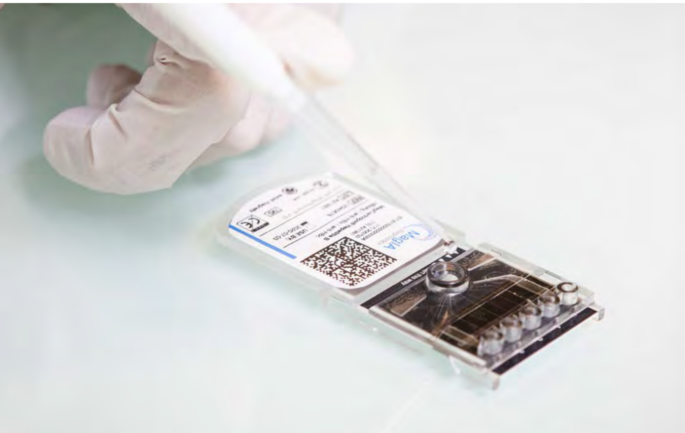
Dispositif portable d'analyses biologiques développé par la start-up MagIA Diagnostics. © Frédérique PLAS / G2Elab / CNRS Photothèque
