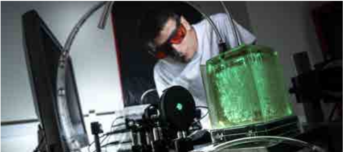
Modèle 3D d'un réseau vasculaire cérébral de souris placé sur une table optique pour y injecter un laser. © Jean-Claude MOSCHETTI / Géosciences Rennes / CNRS Images
