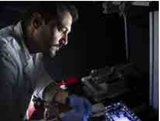
Étude du déplacement d'une phase aqueuse par du CO 2 injecté dans un modèle de fracture géologique. © Jean-Claude MOSCHETTI / Géosciences Rennes / OSERen / CNRS Images
