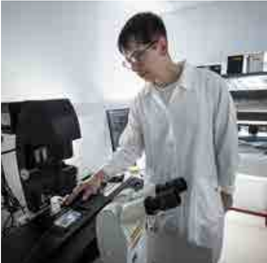
Dispositif pour observer les dynamiques bactériennes à l'échelle microscopique dans une puce microfluidique. © Jean-Claude MOSCHETTI / OSERen / CNRS Images
