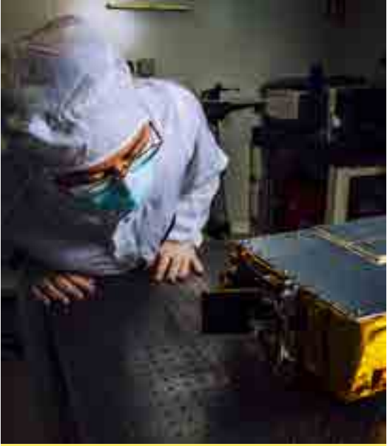
Ouverture du couvercle de protection du spectromètre imageur infrarouge MIRS.
