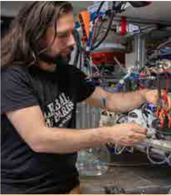
Ajustement de la cellule d'un dispositif de conversion de l'énergie osmotique en électricité.
