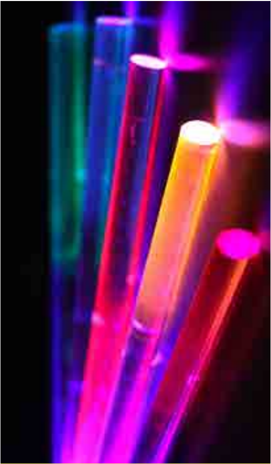
Tubes de Plexiglas recouverts de solutions de nanocristaux de différentes tailles pour ajuster leur couleur.
