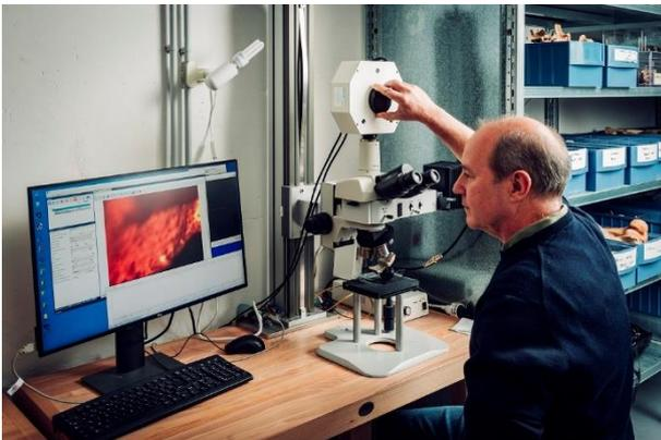
**Le projet Ispahant vise à mettre au point une nouvelle instrumentation** couplant imagerie optique et spectroscopie afin d'étudier chimiquement les traces d'usure sur des objets anciens. Il émane du laboratoire d'archéologie Trajectoires (CNRS/Université Paris 1 Panthéon-Sorbonne). © Cyril Frésillon / Trajectoires / CNRS Photothèque
