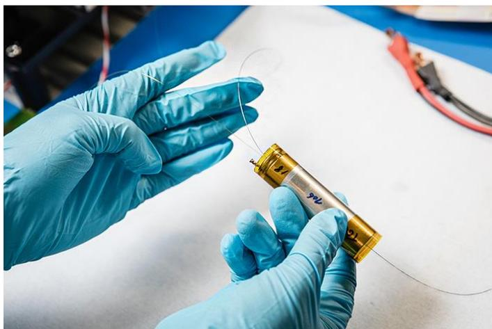
**Batterie traversée par une fibre optique en verre de chalcogénure permettant de transporter de la lumière dans le domaine infrarouge.** L'interaction cette lumière avec les constituants de la batterie permet d'identifier et de suivre les molécules chimiques présentes autour de la fibre.
