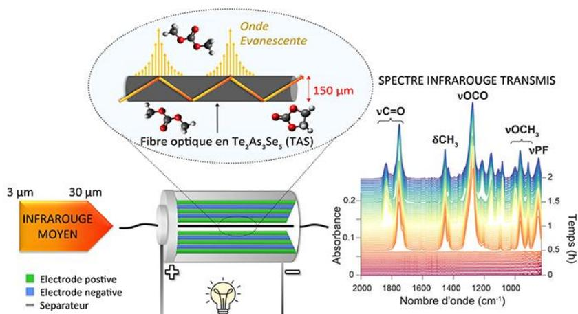
**Schéma de la propagation de la lumière infrarouge à travers le cœur d'une fibre optique en verre de composition :  $\text{Te}_2\text{As}_3\text{Se}_5$  (TAS).** À la surface de la fibre, une onde évanescente est créée et peut interagir avec les molécules environnantes. La fibre TAS est passée à travers un vide au centre d'une batterie de type 18650. Les liaisons chimiques correspondant à l'électrolyte peuvent ainsi être observés lors de son utilisation.
