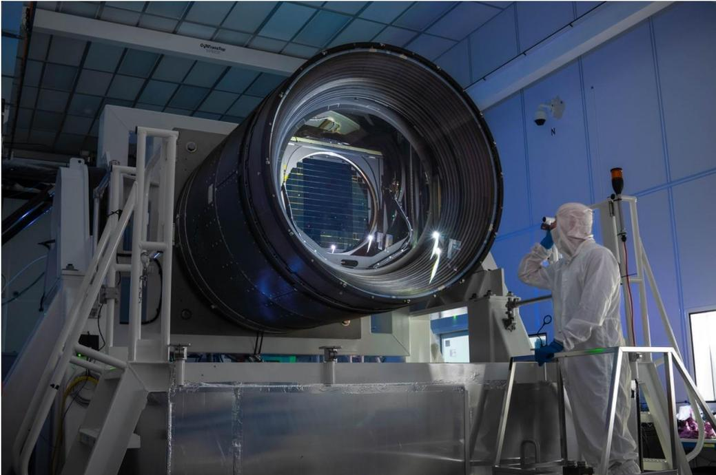
Photographie de la caméra, avec l'un des filtres de couleur positionné. © Olivier Bonin/SLAC National Accelerator Laboratory.
