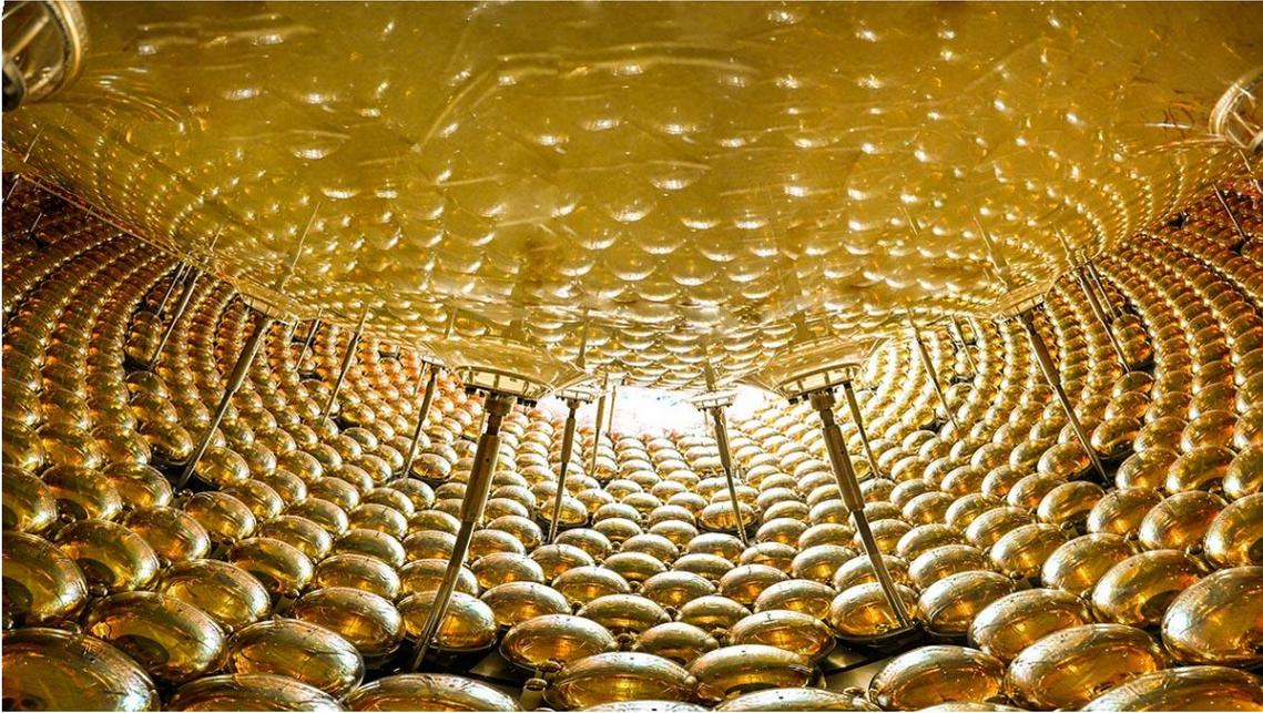
**Les photomultiplicateurs surveillent la sphère de liquide scintillant.** 43212 photomultiplicateurs de deux types surveillent l'émission de lumière dans la sphère de détection de JUNO. Des gros, bien visibles et des petits intercalés entre les gros. © : *Collaboration JUNO*
