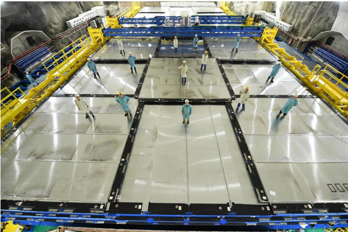
**Le « Top Tracker ».** Le « *Top tracker* » est un détecteur plan placé au-dessus de la sphère de JUNO. Il identifie les particules parasites venues de la surface et qui laissent des traces « trompeuses » dans le détecteur. Le « *Top tracker* » est une des principales contributions matérielles du CNRS à la construction de JUNO. © : *Collaboration JUNO*
