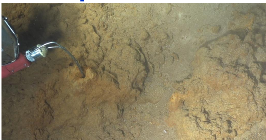
Mesure de température et prélèvement de fluide sur le site Enez Sun depuis le Nautille - CC-BY Ifremer
